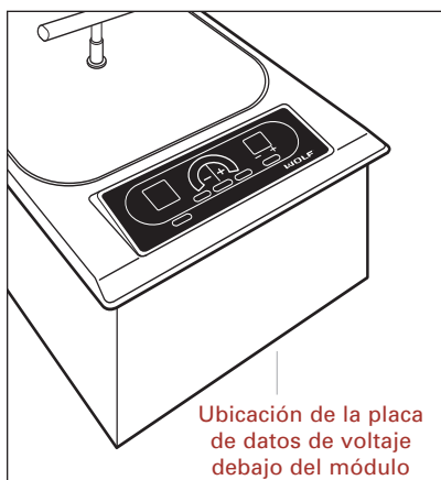
Ubicación de la placa de voltaje
